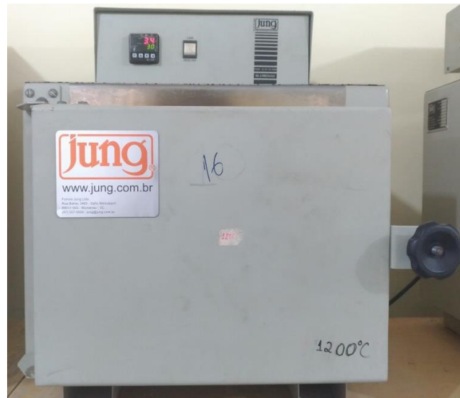
Figura 4 – Forno resistivo da marca Jung.
