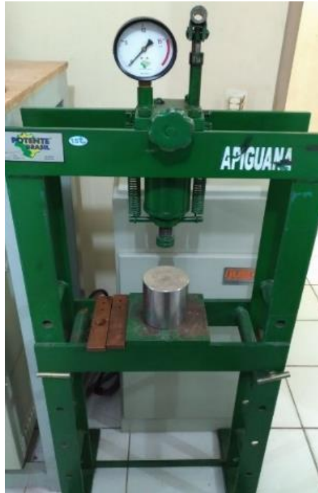
Figura 7 – Molde metálico para obtenção dos discos cerâmicos.
