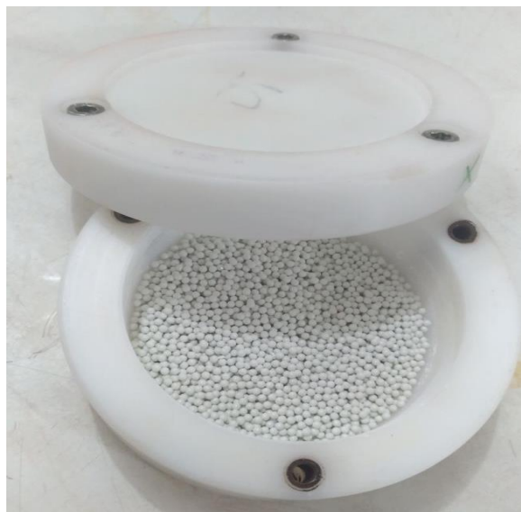
Figura 2– Recipiente de poliacetal com esferas óxido de zircônio usados na etapa de moagem.
