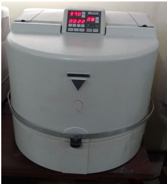
Figura 3 – Moinho do tipo planetário da marca Fritsch modelo Pulverisette 5.
