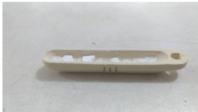
Figura 5 – Cadinho de alumina com o material sintetizado.
