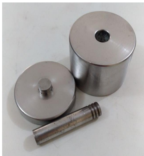
Figura 7 – Molde metálico para obtenção dos discos cerâmicos.
