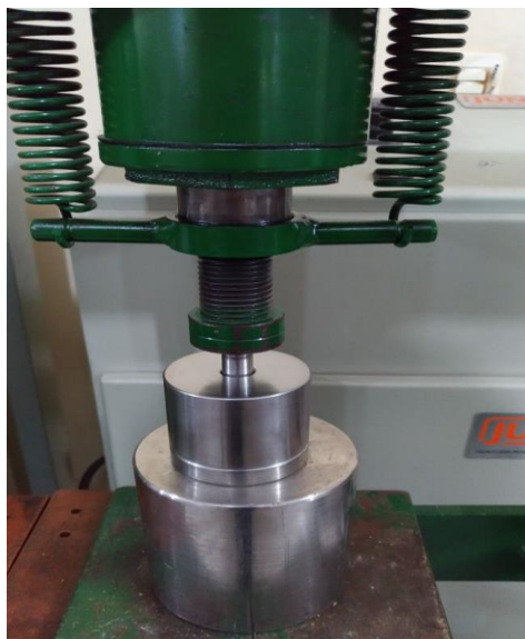
Figura 8– Estrutura para obtenção dos discos cerâmicos.
