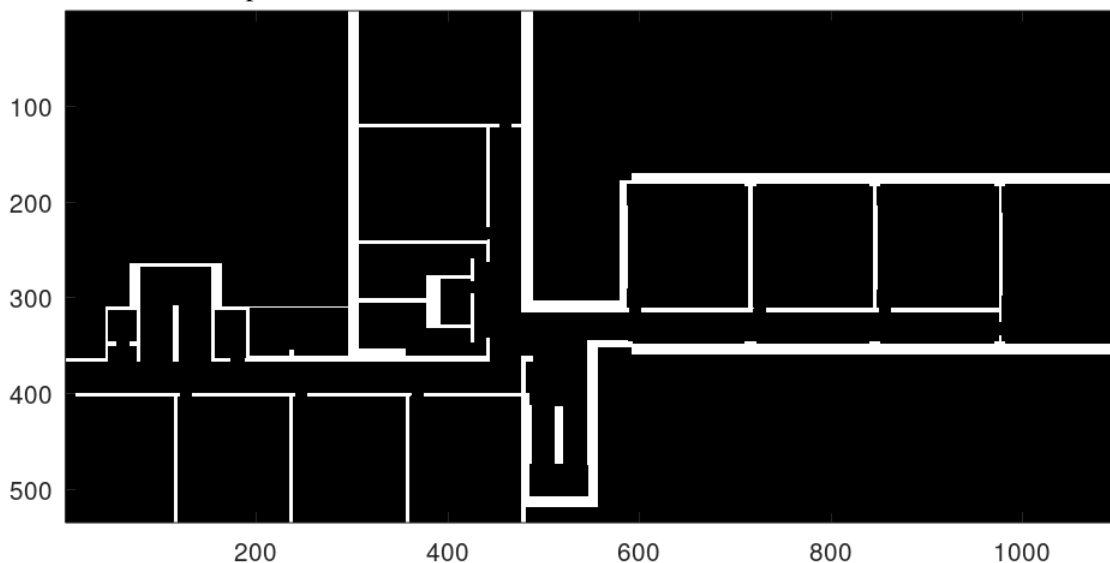
Figura 20 – Exemplo de uma planta baixa de 534x1103 pixels e resolução de 0,06 m/pixel.
