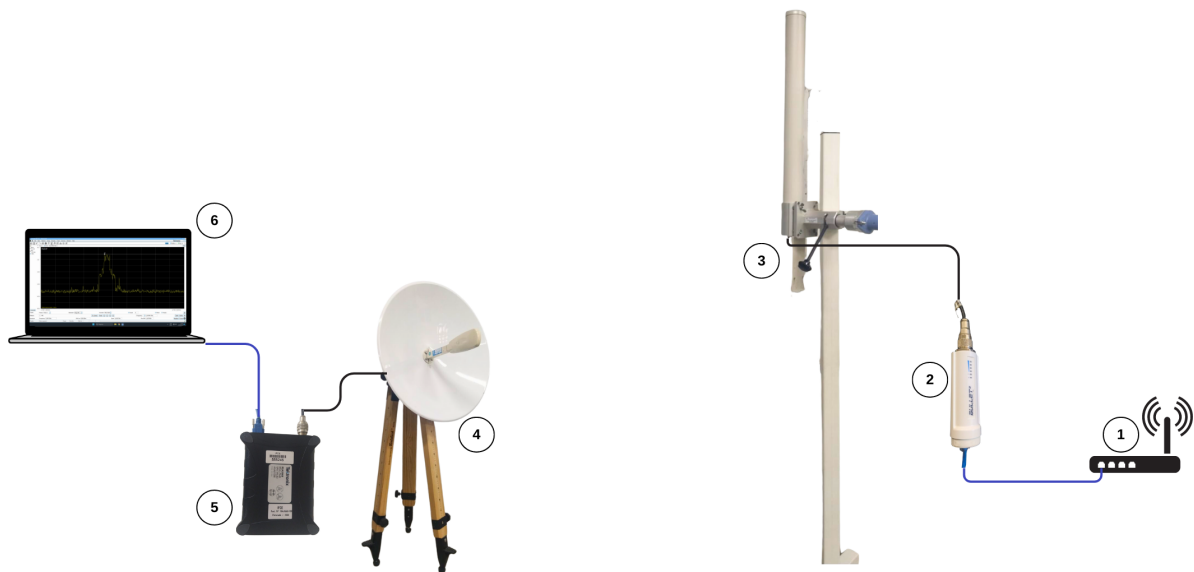
Figura 3 – Topologia dos equipamentos utilizados nas medições.
