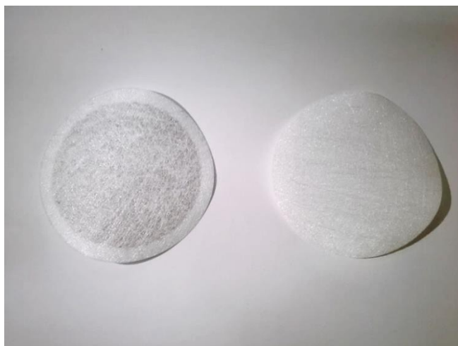
Figura 6 – Fotografia da membrana filtrante de teflon (PTFE) não amostrada e amostrada após 24 horas.
