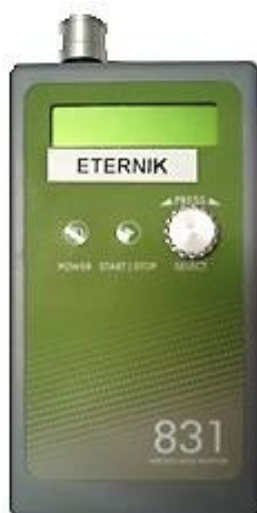
Figura 8 – Fotografia do contador de partículas 831 Aerosol Mass MetOne® .
