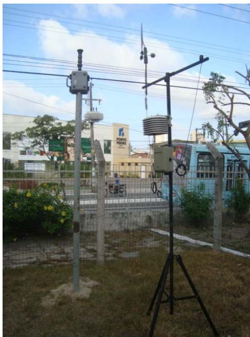
Figura 2– Fotografia da estação meteorológica automática do Lerca.
