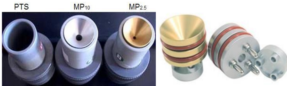
Figura 4 – Fotografias das seções seletoras de partículas do impactador do MiniVol TAS.
