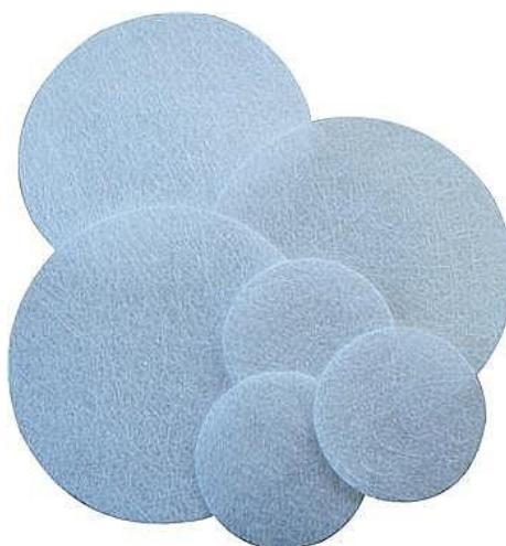
Figura 5 – Fotografia de membrana filtrante de Telfon (PTFE)
