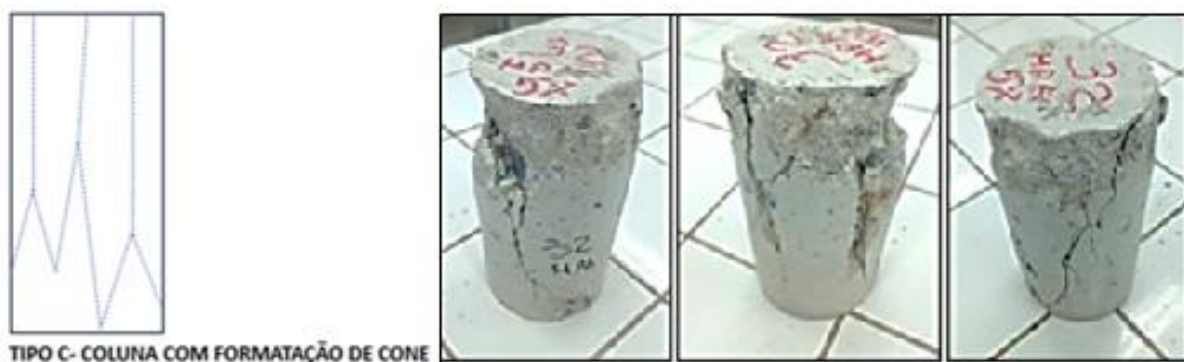
Figura 14 - Rompimento do CP 9 do concreto com 5% de CIRSP
