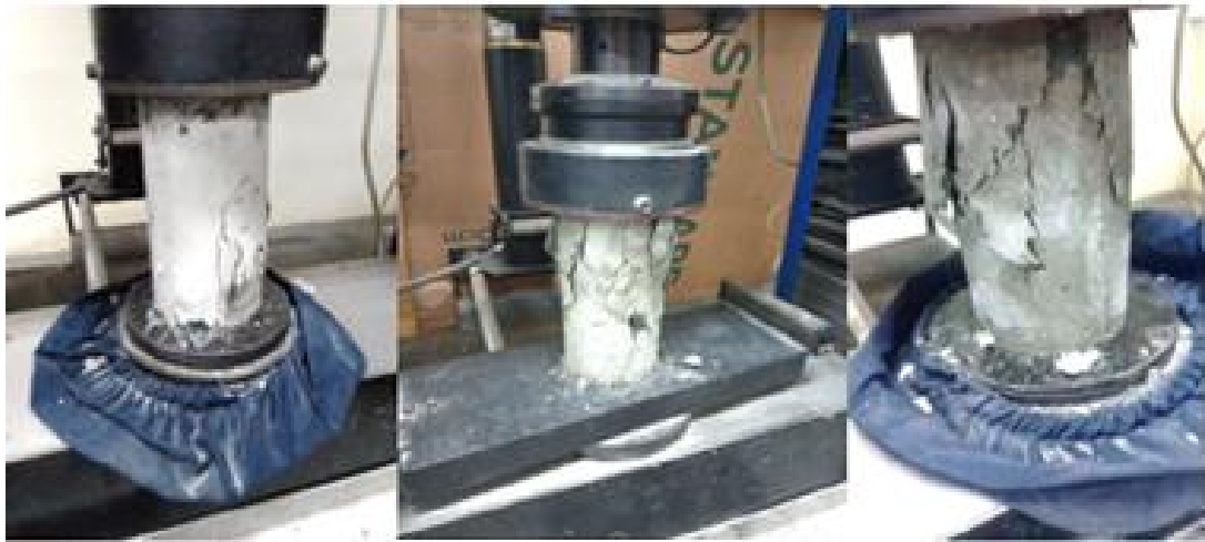
Figura 6 - Ensaio de rompimento de alguns corpos de prova aos 28 dias
