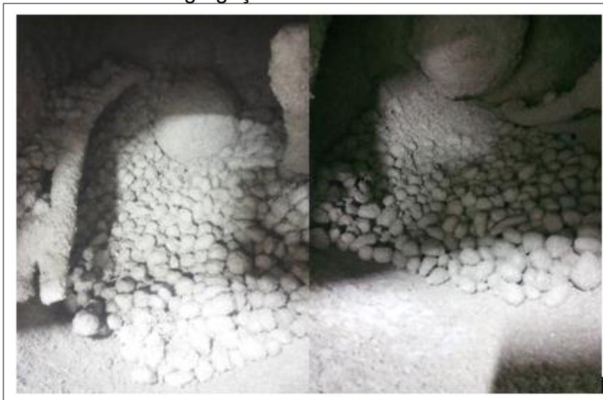
Figura 19 - Concreto em desagregação na betoneira com 20% e 25% de CIRSP
