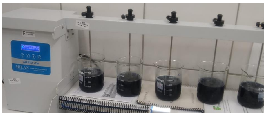
Figura 7 — Ensaios de coagulação/floculação/decantação no Jar-Test .
