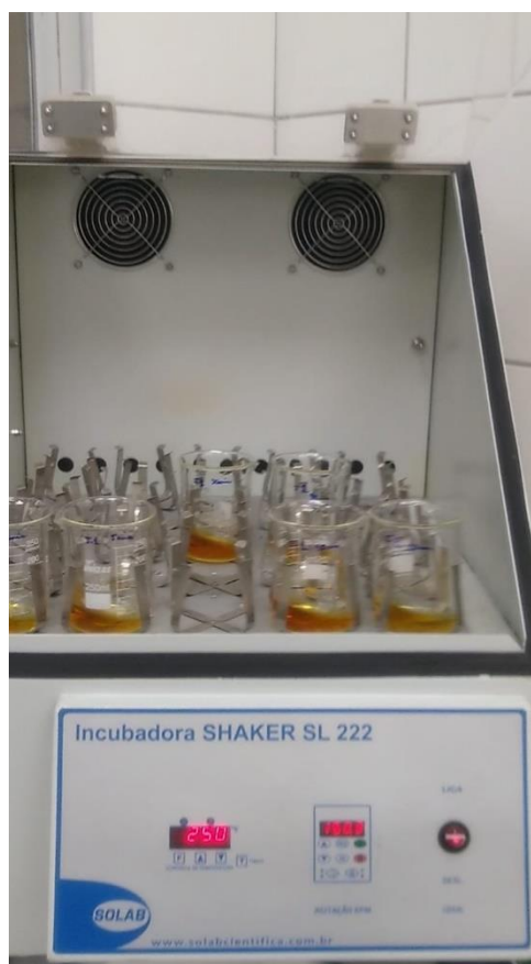
Figura 8 — Ensaio reação Fenton em incubadora shaker orbital.
