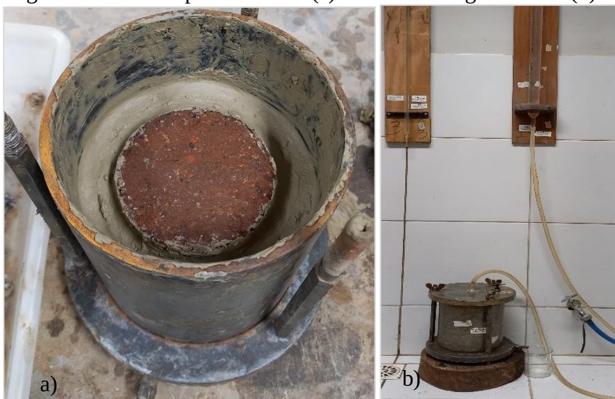
Figura 14 – CP em permeâmetro (a) e ensaio a carga variável (b).
