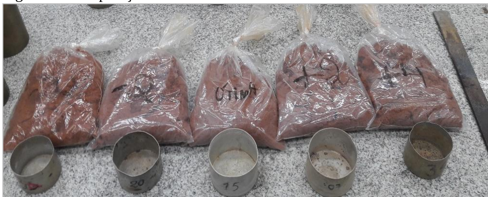
Figura 12 – Preparação de amostra - ensaio de mini-MCV.
