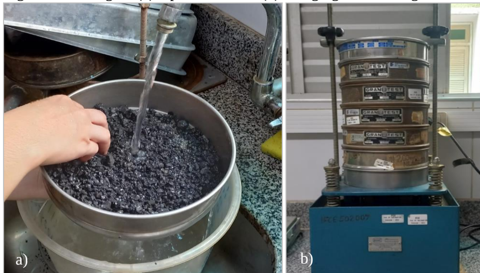
Figura 9 – Lavagem (a) e peneiramento (b) do agregado siderúrgico
