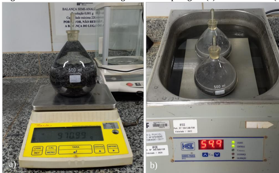
Figura 10 – Densidade real dos grãos do AS: pesagem (a) e banho-maria (b).
