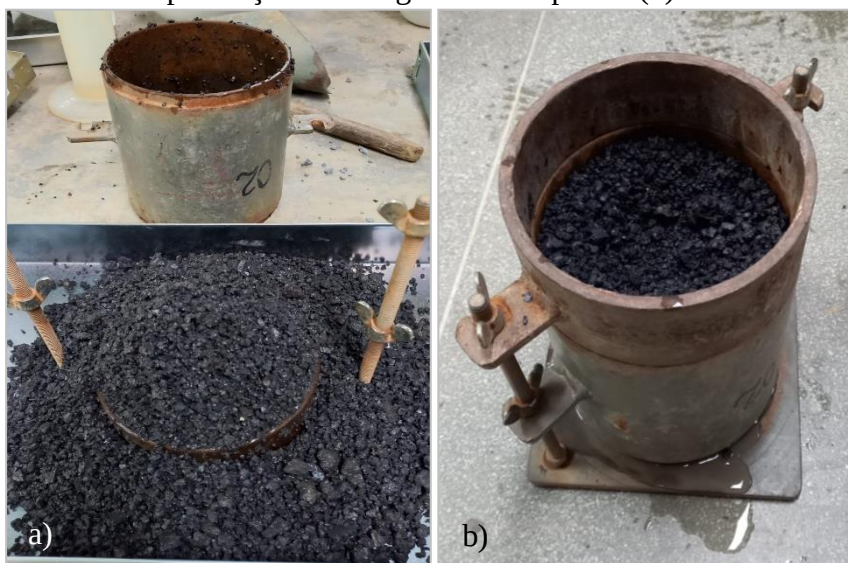
Figura 25 – Tentativa de ensaio de compactação do agregado (a) e detalhe da presença de drenagem ao compactar (b).
