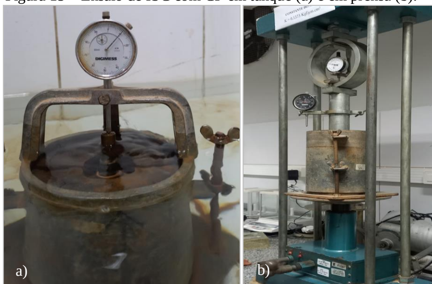
Figura 15 – Ensaio de ISC com CP em tanque (a) e em prensa (b).
