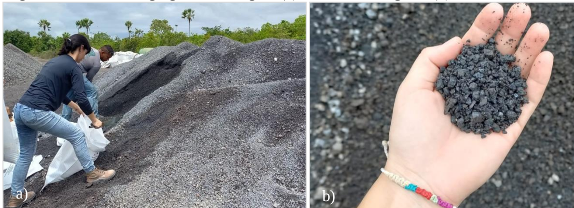
Figura 6 – Coleta do agregado siderúrgico (a) e amostra dos grãos (b).
