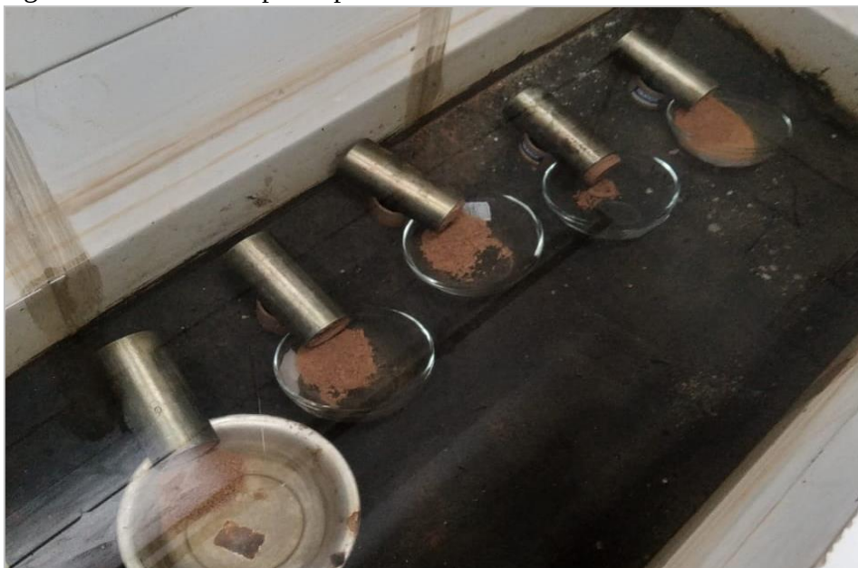
Figura 13 – Ensaio de perda por imersão.
