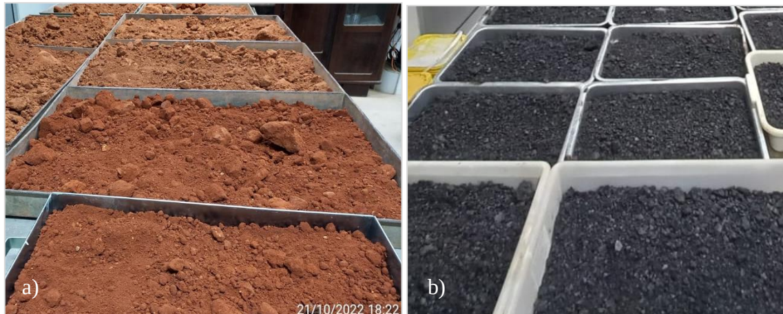
Figura 8 – Secagem do solo natural (a) e do agregado siderúrgico (b) coletados.
