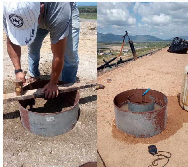
Figura 14 - Ensaio de permeabilidade in situ no solo de cobertura
