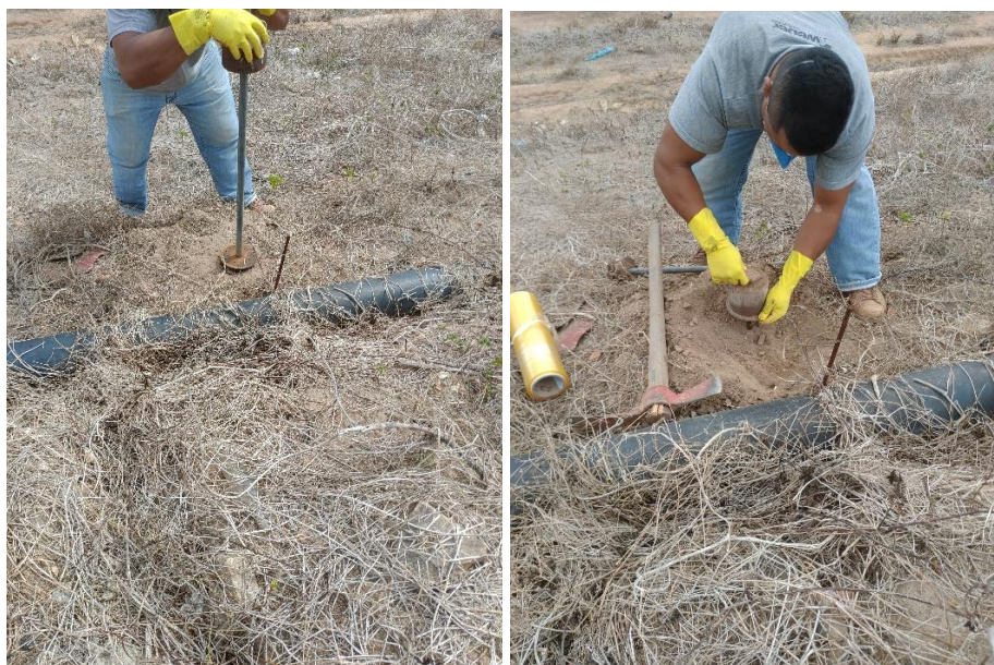
Figura 11 - Extração das amostras indeformadas das camadas de cobertura do aterro
