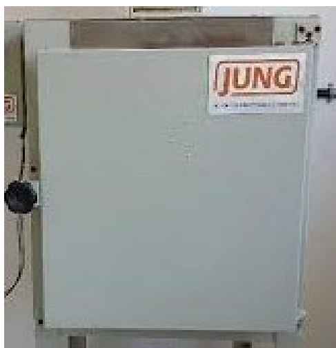
Figura 21 – Forno Resistivo da marca JUNG.
