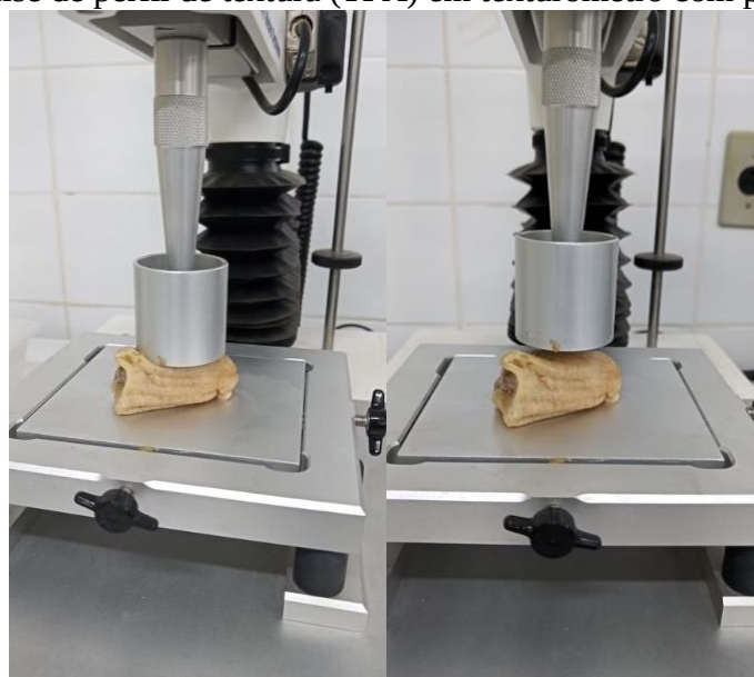
Figura 3.7 - Análise de perfil de textura (TPA) em texturômetro com probe P/36 R.
