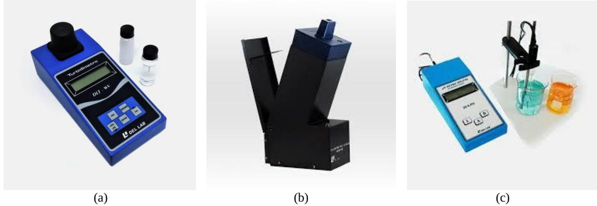
Figura 7 – Equipamentos utilizados nos ensaios de caracterização. (a) turbidímetro digital; (b) colorímetro visual; (c) pHmetro digital.
