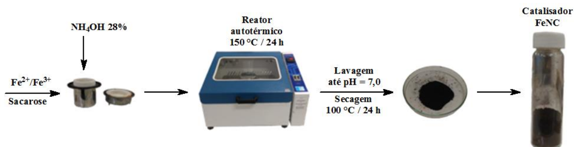
Figura 4 – Esquema geral de síntese do nanocompósito de ferro e carbono (FeNC).
