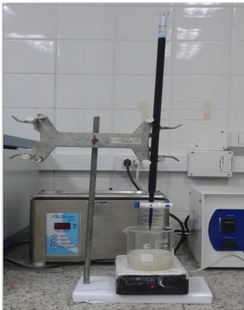
Figura 13- Equipamentos utilizados na execução do teste da mancha.
