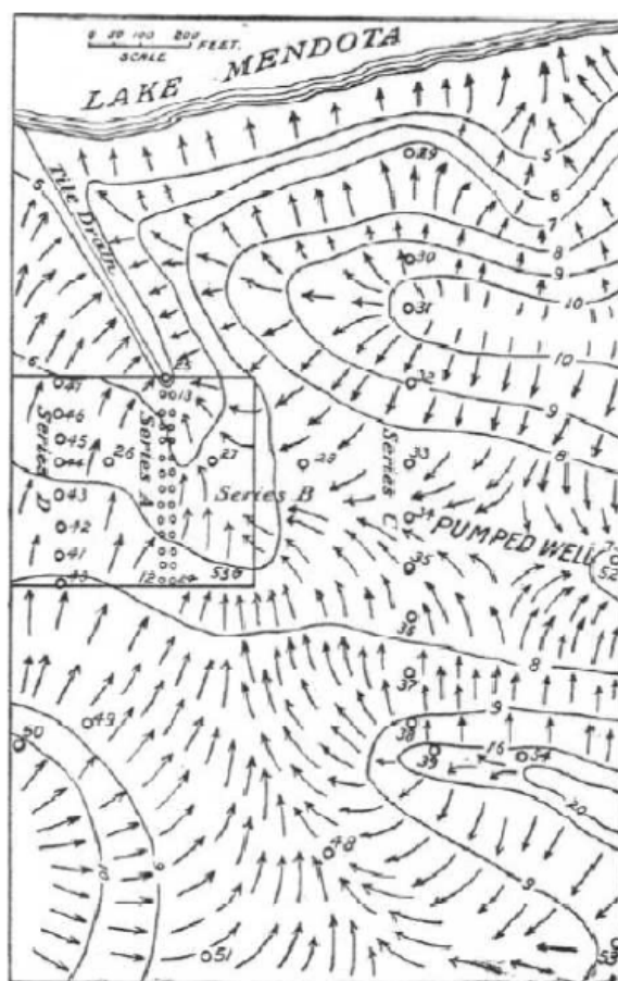
Figura 4 – Linhas de fluxo a partir disso linhas de carga hidráulica King (1899) apud Fetter Jr. (2004b).
