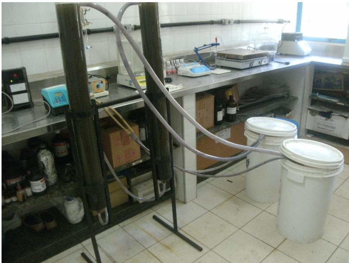
Figura 6 – Unidade Experimental de Sedimentação (UES) em atividade.
