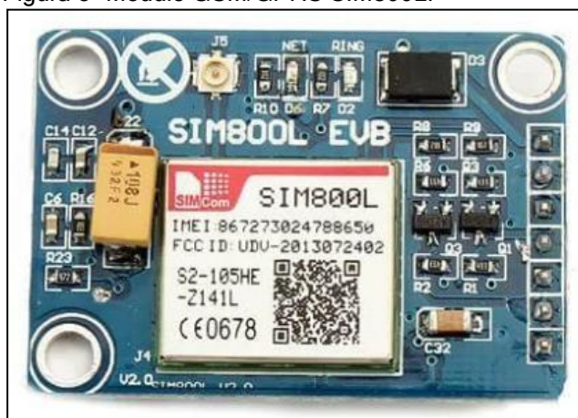
Figura 5- Módulo GSM/GPRS SIM800L.
