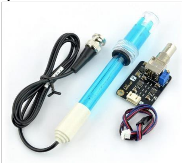
Figura 14- Sensor PH-4502C e sonda.
