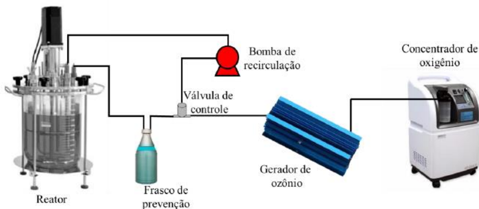
Figura 96 - Imagem esquemática do aparato experimental para remoção de fármacos
