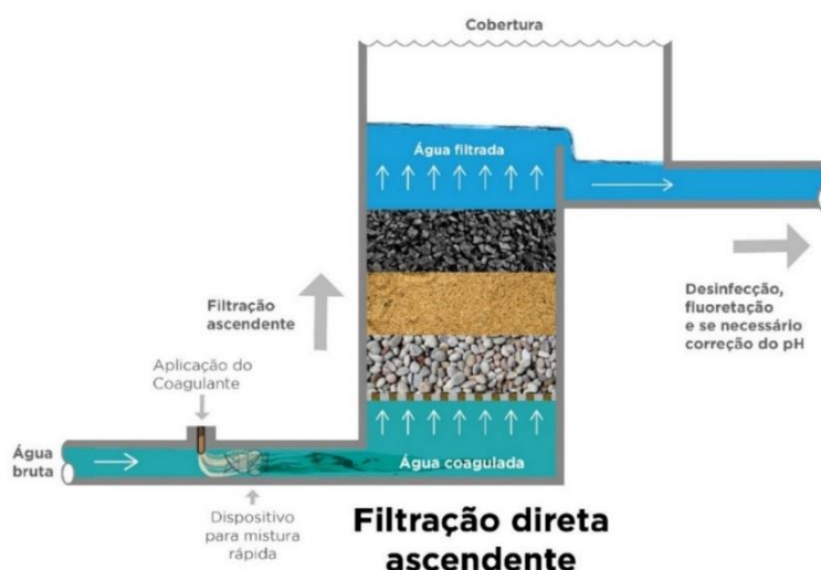
Figura 3 — Representação da filtração direta ascendente
