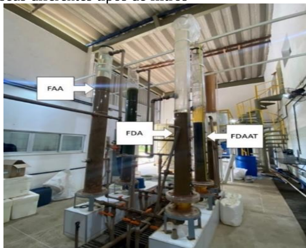
Figura 9 — ETA piloto utilizada na pesquisa com seus diferentes tipos de filtros
