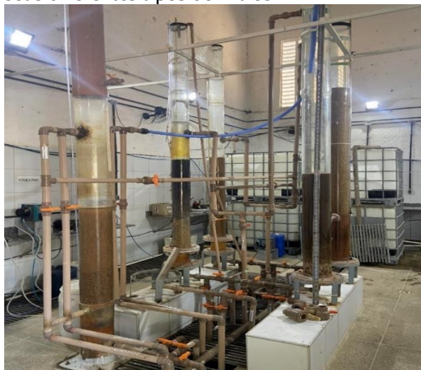
Figura 8 — ETA piloto utilizada na pesquisa com seus diferentes tipos de filtros
