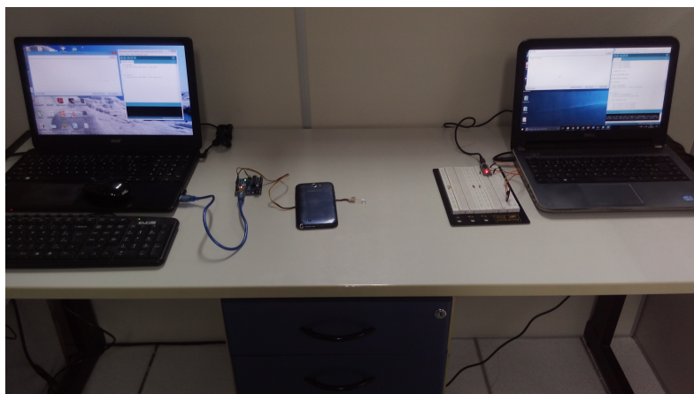
Figura 3.6: Estrutura de rede de comunicação FSO ponto a ponto com tx de Led
