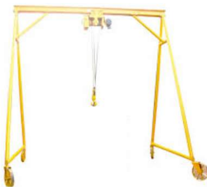
Pórtico e Talha - Foto 2019
